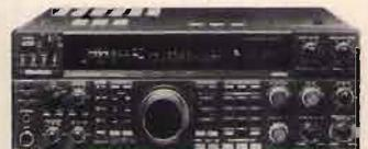
TS950SD - Ricetrasmittitore HF 100 kHz, 30 MHz (RS) - Modi SSB-CW-AM-FM-FSK - Potenza 150 W output - Processore digitale del segnale (DSP) - Doppio ascolto e lettura - Filtri inseribili indipendentemente dal modo di ricezione - Accordatore automatico controllato dal microprocessore.
